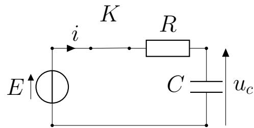
établir l'équation différentielle vérifiée par la tension  $u_C$  sous forme canonique.
