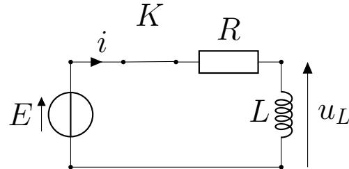
établir l'équation différentielle vérifiée par la tension  $u_L$  sous forme canonique.
